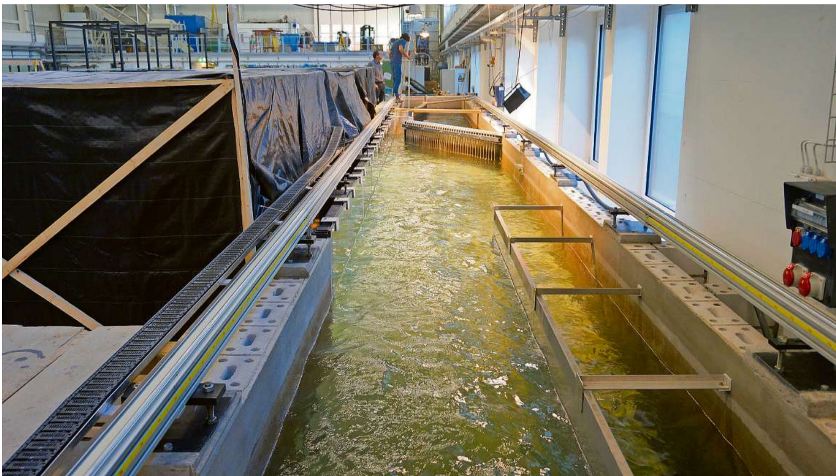
Entwicklung im Labor: Forschende bauen an der der Versuchsanstalt für Wasserbau, Hydrologie und Glaziologie an der ETH Zürich den neu gestalteten Fischleitrechen und einen seitlichen Bypasskanal und beobachten die Wanderung der Fische den Fluss hinunter.
